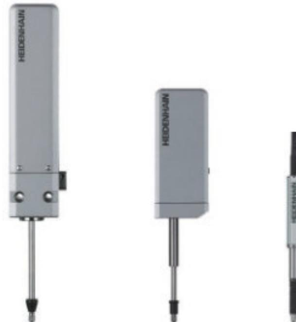
Les systèmes de mesure linéaires incrémentaux déterminent la position actuelle, soit en comptant les incréments de mesure à partir d'un point d'origine, soit en subdivisant et en comptant les périodes de signal. Pour retrouver un point d'origine, les codeurs incrémentaux de HEIDENHAIN possèdent des marques de référence qui doivent être franchies à la mise sous tension. Cette procédure est simple et rapide avec des marques de référence à distances codées.
