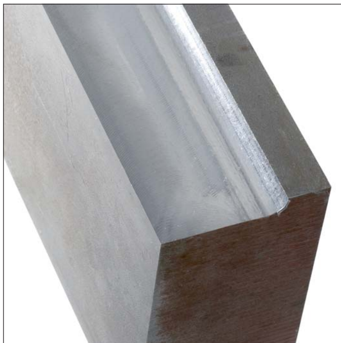
Pièce fraisée avec la fonction ACC : avec la même avance et la même profondeur de coupe, la surface ne présente pas de marques laissées par les vibrations. L'usinage est effectué en préservant l'outil et la machine.
