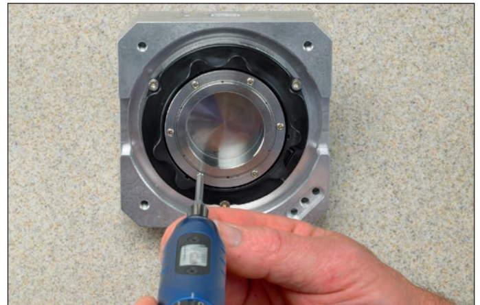
Montage d'un ECI 119
