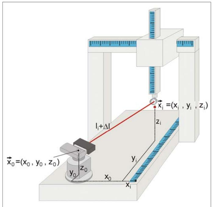
Calcul des erreurs géométriques avec un appareil laser de mesure de coordonnées (source : information 117 du PTB)
