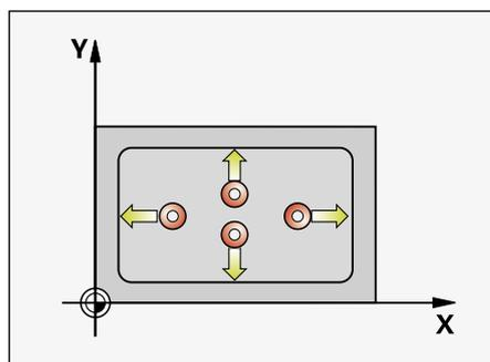
**Etalonnage de pièces** par ex. d'un angle dans un plan ou d'une poche rectangulaire
