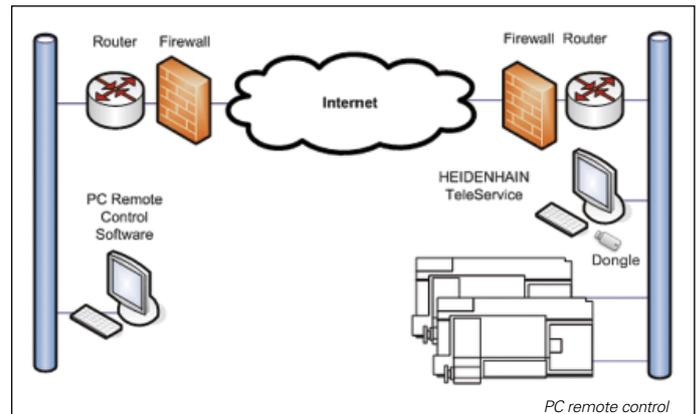
Liaison à distance avec un logiciel de contrôle à distance pour PC
