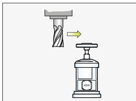
**Etalonnage d'outils** par ex. de la longueur et du rayon de l'outil ou de l'usure de l'outil
