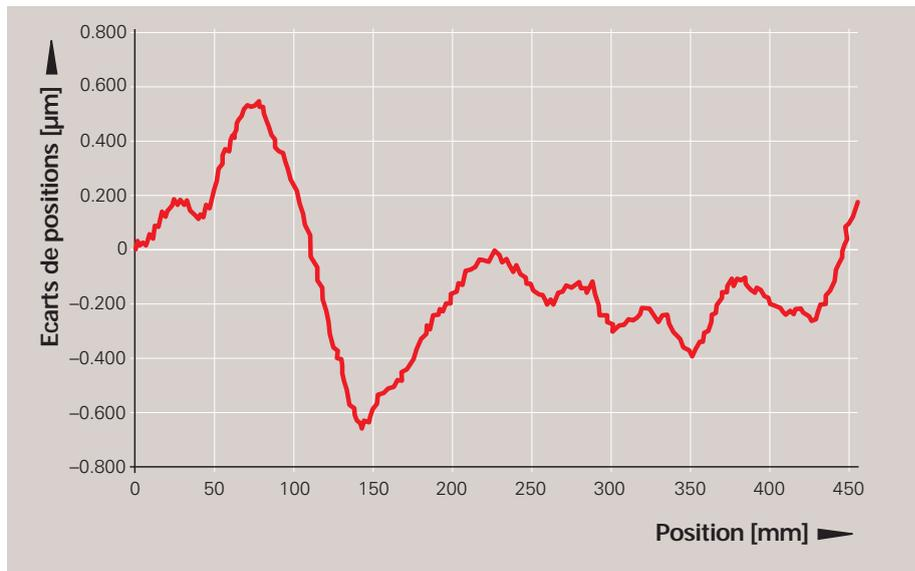
Fig. 1: Ecart de positions classiques sur la longueur de mesure ML
