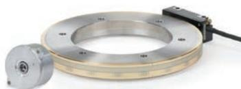
Les **systèmes de mesure angulaire incrémentaux et les capteurs rotatifs** déterminent la position actuelle – mesurée à partir d'un point d'origine – en comptant les pas de mesure ou en subdivisant et comptant les périodes de signal. Pour retrouver le point d'origine, les systèmes de mesure incrémentaux HEIDENHAIN sont dotés de marques de référence.
